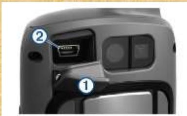
La batería se puede recargar a través del puerto mini-USB. Levanta el protector de goma (1) y enchufa el cable por su puerto mini-USB en el puerto USB del GPS (2), el otro extremo del cable lo conectas a una toma de red (a través de un adaptador USB) o al puerto USB de tu PC.
