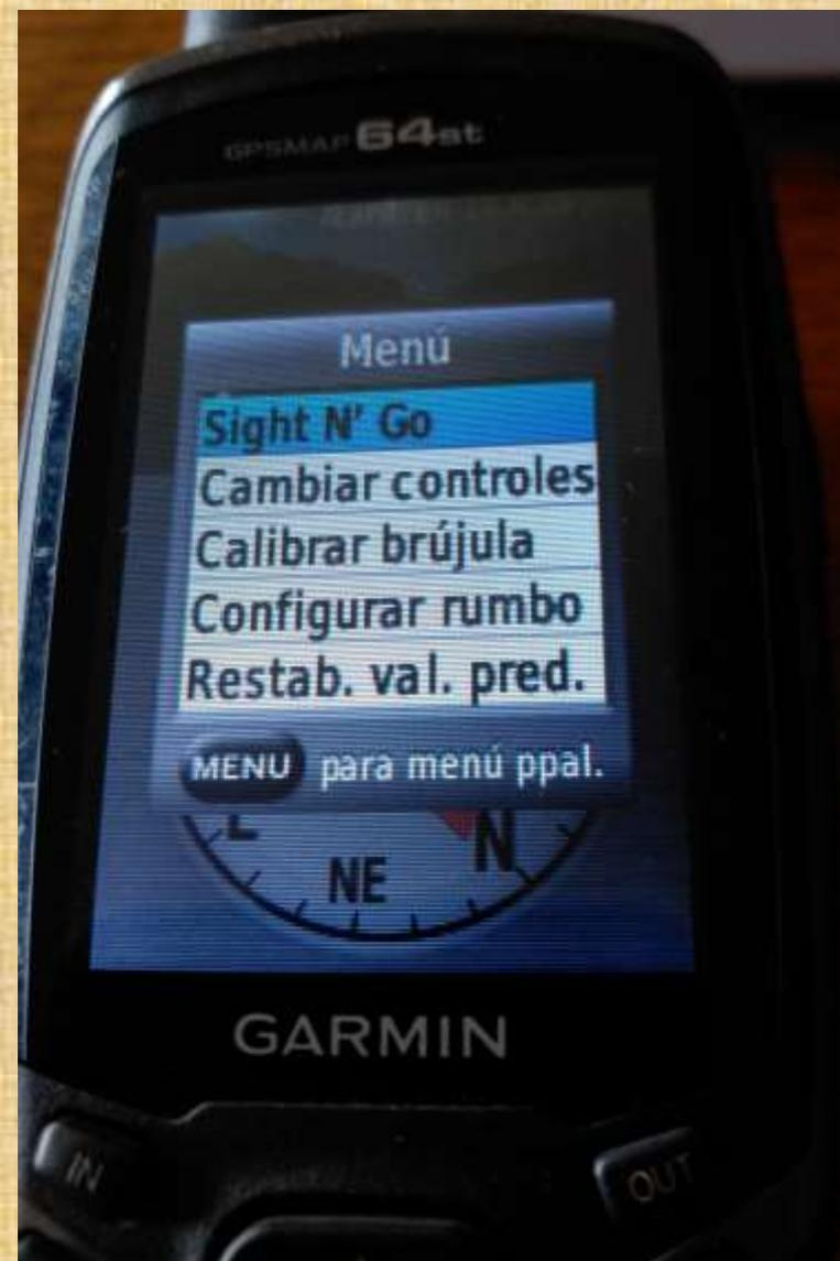
Para ello hay que girar, lentamente, en diferentes posiciones, el dispositivo según te vaya indicando el sistema.
