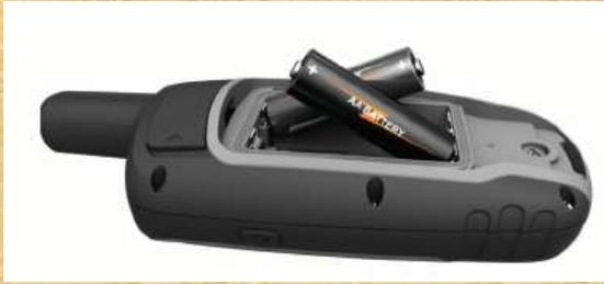
Si utilizas pilas tienes que decirle al GPS de que tipo son: Alcalinas, Litio,..., etc. Para hacerlo tienes que ir a través del botón Menú>Configuración >Sistema: Tipo de pilas AA.
